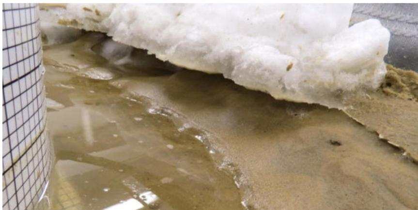
Рис. 4. Ниша вымывания замороженного склона
