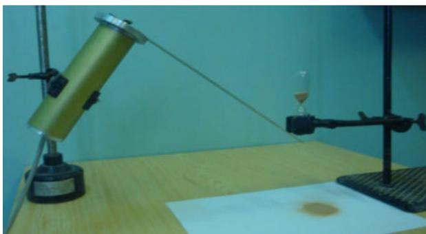
Рис. 8. Лабораторный стенд для градуировки ПАЭ
