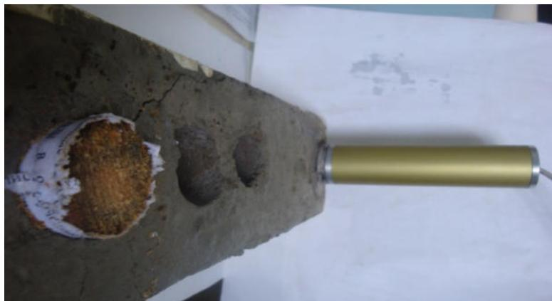
Рис. 10. Регистрация АЭ сигналов ПАЭ образования трещины в бетонном стенде
