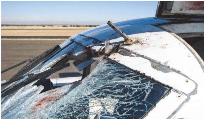
Рис. 1. Разбитое окно в кабине пилотов при столкновении с птицей
