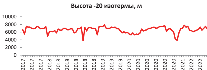
Рис. 4. График высоты -20 изотермы на аэродроме Иркутск с 2017–2022 гг.
