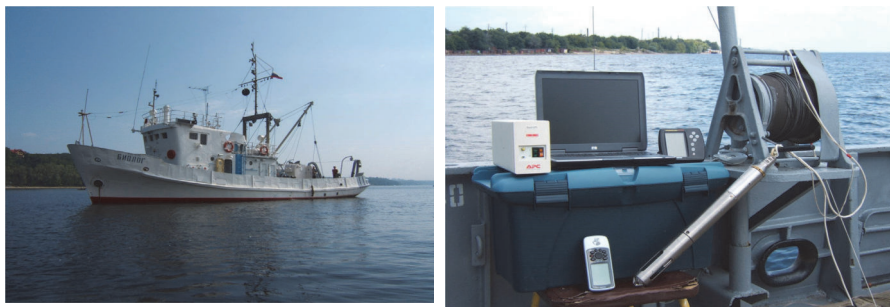
Рис. 2. Научное судно «Биолог» (слева) и система контроля качества воды «Хитон» для диагностики пространственных неоднородностей (справа)
