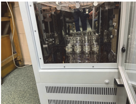
Рис. 7. Стаканчики с D. magna в климатате (автоматически поддерживает необходимые параметры для биотестов – освещение и температуру)
