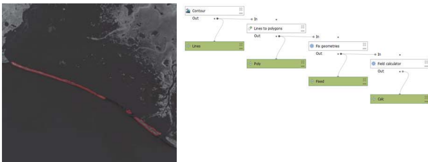
Рис. 4. Границы о. Ярки (векторный слой) и фрагмент алгоритма обработки данных для определения границ и создания полигонального слоя о. Ярки
