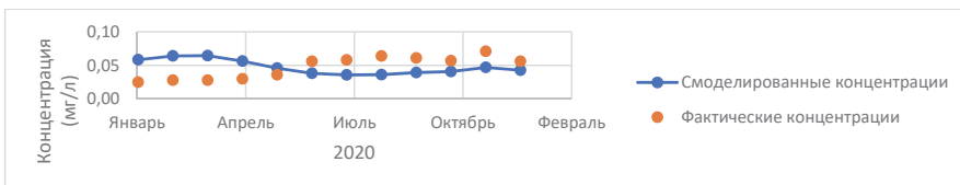
Рис. 5. График-сравнение смоделированных концентраций фосфора и фактически измеренных на р. Гороховка
