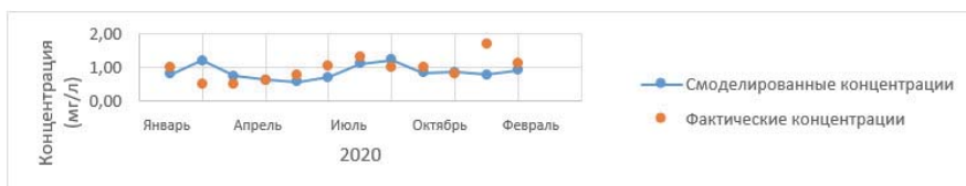
Рис. 7. График-сравнение смоделированных концентраций азота и фактически измеренных на р. Черная
