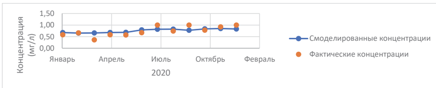
Рис. 3. График-сравнение смоделированных концентраций азота и фактически измеренных на р. Гороховка
